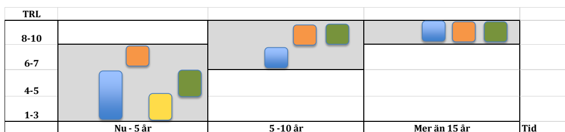
Figur 3: Roadmap för kompositer. Grå färg visar intervallet för TRL-nivåer inom alla applikationsområden. De olika applikationsområdena visas i olika färger - blå: polymerkompositer för mekanisk förstärkning, orange: polymerkompositer som utnyttjar elektriskt ledande förmåga, gul: metallkompositer och grön: keramkompositer.
